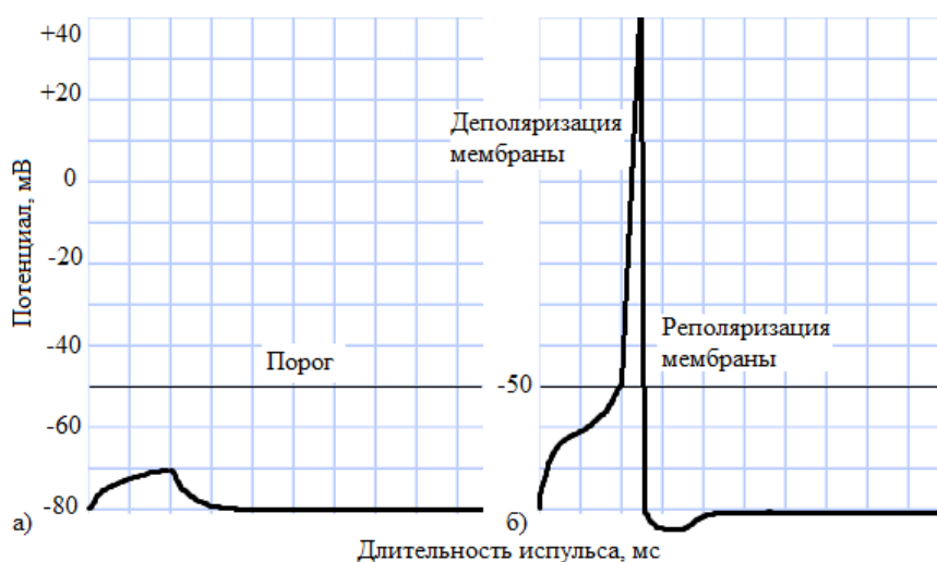
Рисунок 4 – Возбуждение мембраны аксона: а – подпороговый импульс, б – появление потенциала действия при надпороговом импульсе
