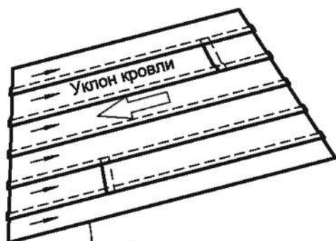
а — укладка рулонного кровельного материала на скате крыши вдоль уклона
