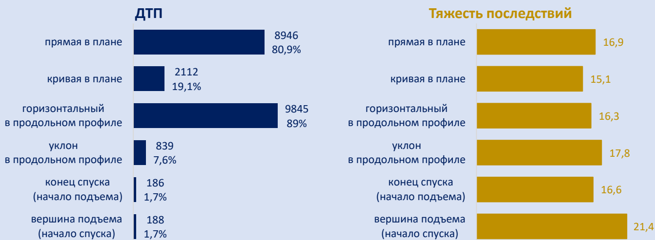
Рис. 3.1.21. Распределение количества ДТП из-за выезда на полосу, предназначенную для встречного движения, в зависимости от элемента плана и продольного профиля дороги и тяжесть последствий
