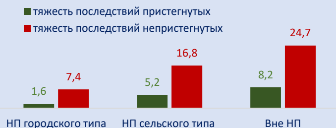
Рис. 5.2. Показатель тяжести последствий в зависимости от пристегивания пассажиров ТС при условии, что конструктивно такая возможность имелась, в различных местах совершения ДТП
