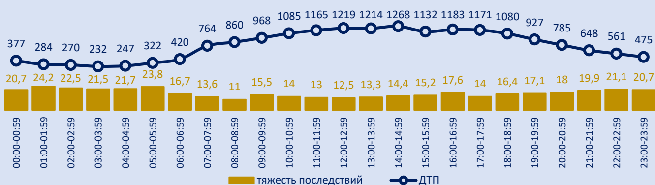
Рис. 4.2.5. Количество ДТП с участием грузовых ТС и тяжесть последствий в зависимости от времени суток
