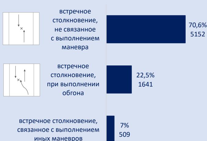
Рис. 3.1.17. Распределение столкновений ТС, связанных с выездом на ПВД на дорогах с двумя полосами движения при движении ТС во встречном направлении в зависимости от выполняемого маневра
