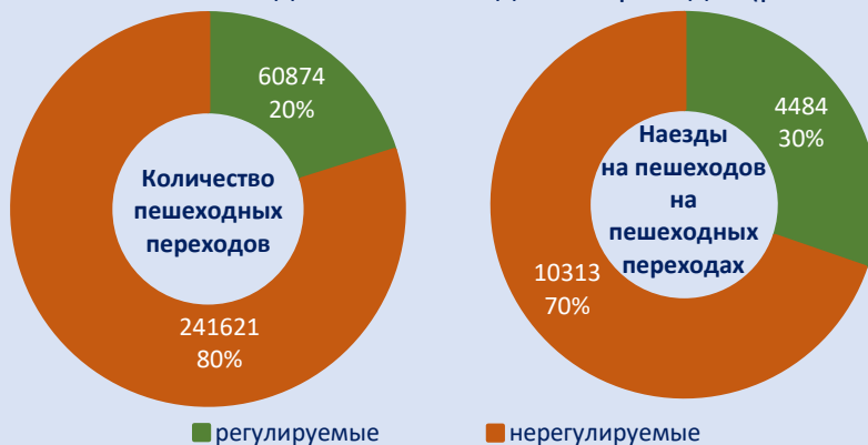
Рис. 6.14. Распределение пешеходных переходов и наездов на пешеходов в зависимости от вида пешеходного перехода
