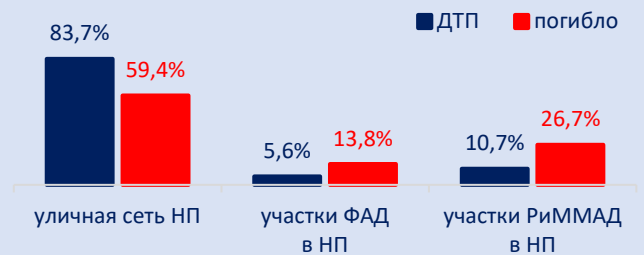
Рис. 2.10. Соотношение долей количества ДТП и числа погибших на участках различных дорог в НП
